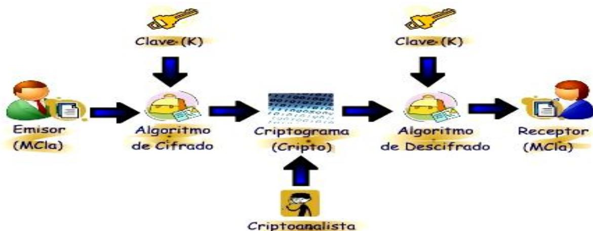
Figura 1: Sistema criptográfico simétrico. Fuente (Laboratorio de Redes y Seguridad. UNAM - Facultad de Ingeniería, División de Ingeniería Eléctrica, 2012)
