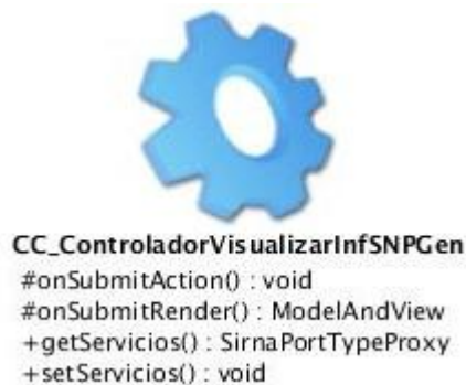
Figura. 5 Representación del Patrón Bajo Acoplamiento en el Diseño del Sistema. Explica cómo dar soporte a una dependencia escasa y a un aumento de la reutilización.
