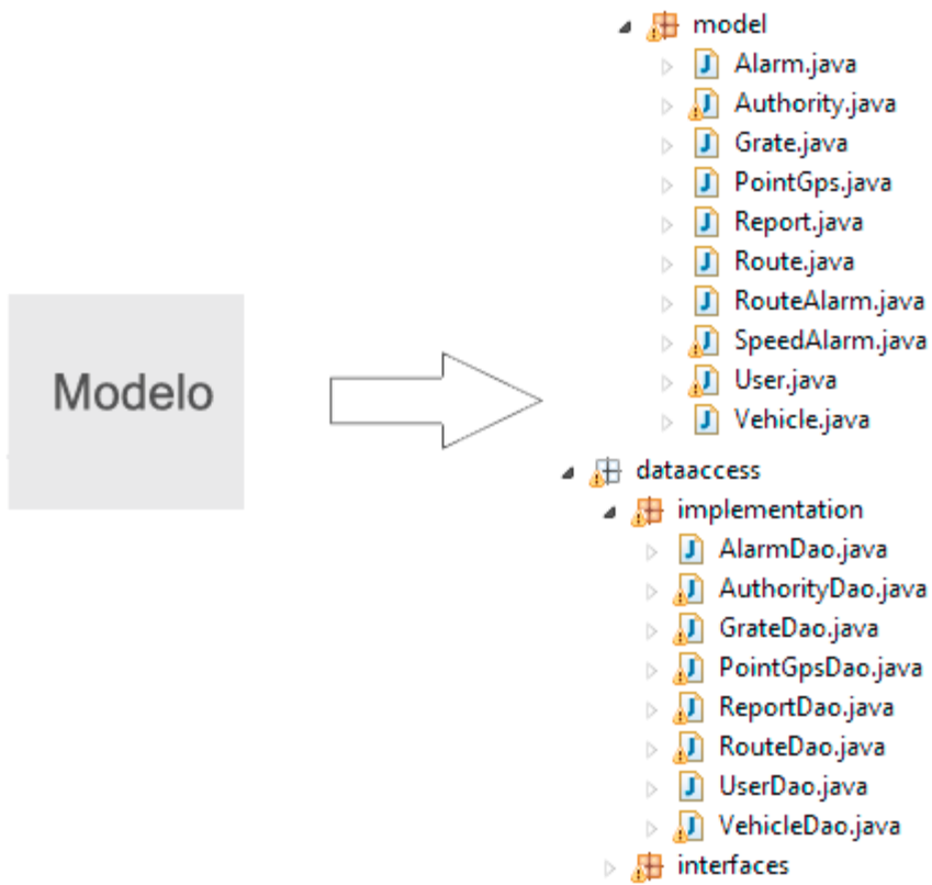
Figura 3.3. Paquetes de clases del sistema que pertenecen a la capa Modelo en la arquitectura MVC.
