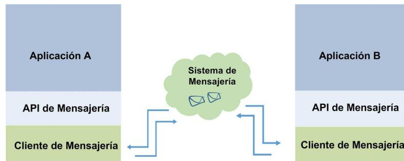
**Figura 3: Comunicación basada en mensajes a través de un MOM.**
