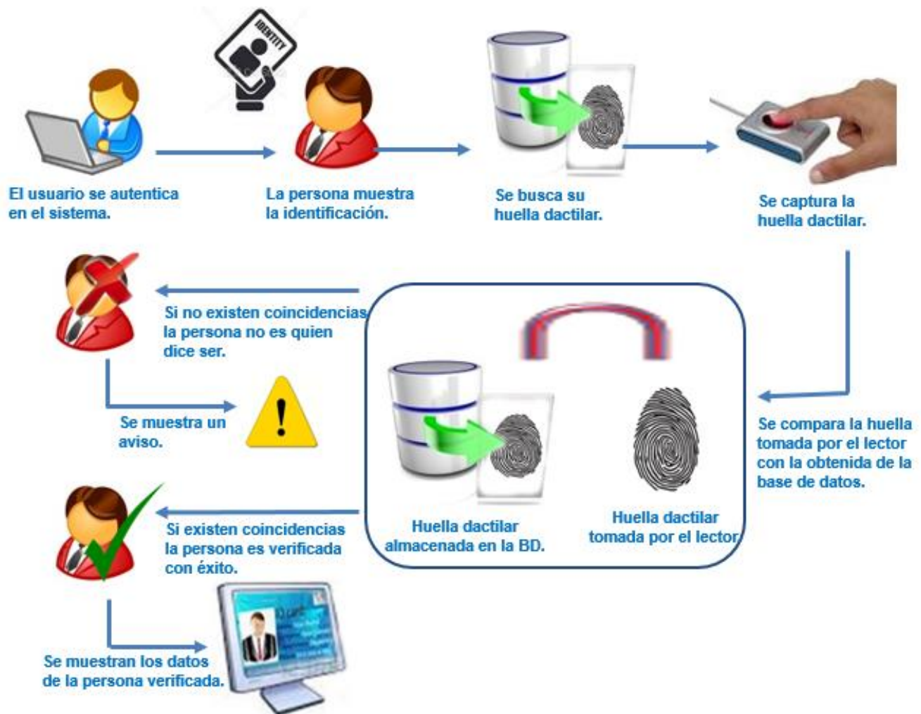
Figura 11. Flujo del proceso de verificación de personas a través de huellas dactilares en el sistema.
