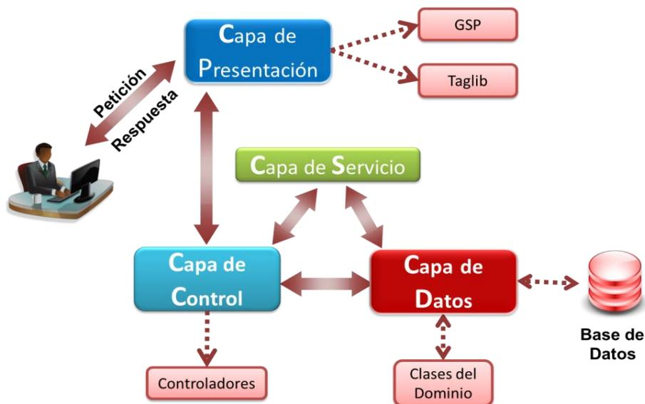
Figura 10 Esquema del Patrón MVC en Grails. Elaboración Propia.
