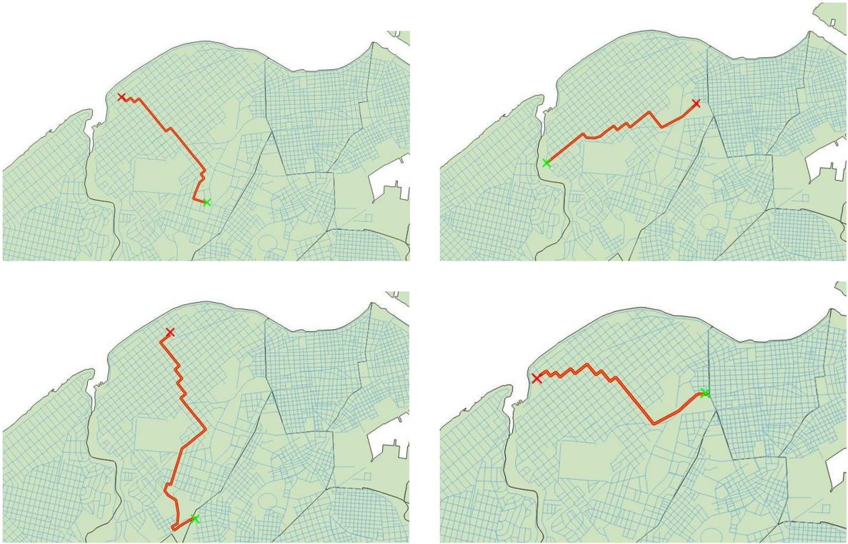
**Figura 3.3:** Ejemplo de búsqueda de camino óptimo con el plugin desarrollado para el SIG QGIS.
