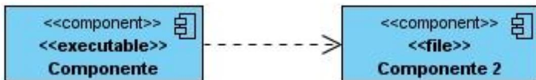
Figura 8. Diagrama de componentes (vista de implementación)
