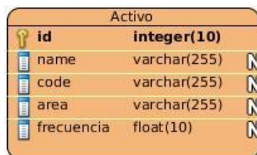
Ilustración 8 Modelo de Datos para el módulo Diagrama de Pareto a través de UML.
