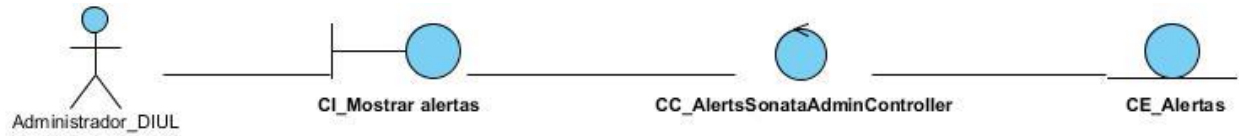
Ilustración 26. Diagrama de clases del análisis del requisito funcional mostrar alertas.
