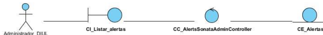
Ilustración 22. Diagrama de clases del análisis del requisito funcional listar alertas.
