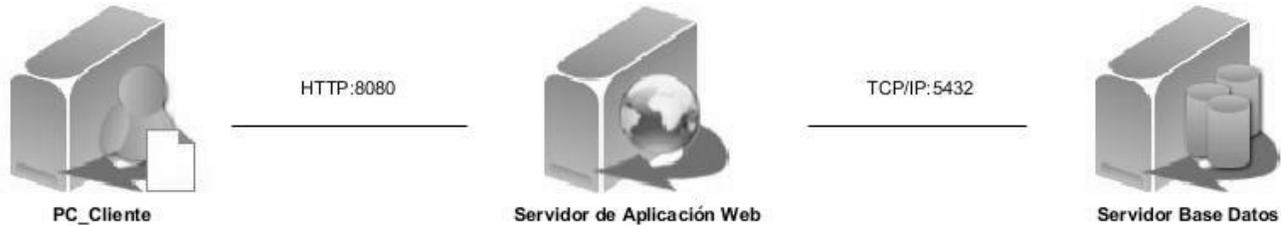
**Ilustración 1: Diagrama de despliegue.**
