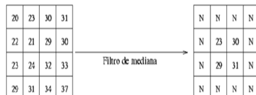
Figura 1.3. Ejemplo de filtro no lineal .
