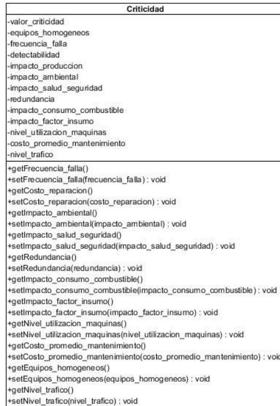
Figura 7: Ejemplo del patrón Active Record empleado en la implementación de la herramienta a través de un diagrama UML.
