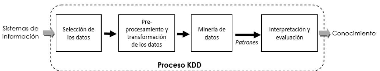
Figura 1.3: Fases resumidas del proceso KDD, tomado de (Moine, 2013).
