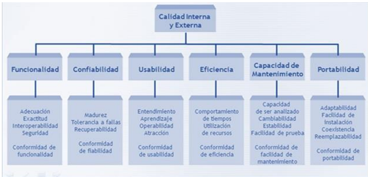
Figura 1.2: Estructura de las características y subcaracterísticas de la Norma ISO 9126-1.
