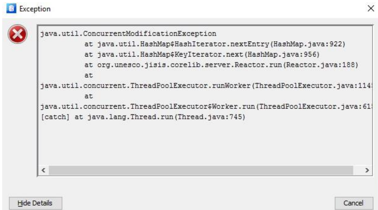
Figura 29. Excepción mostrada por J-ISIS al realizar peticiones concurrentes (Fuente: Elaboración propia)
