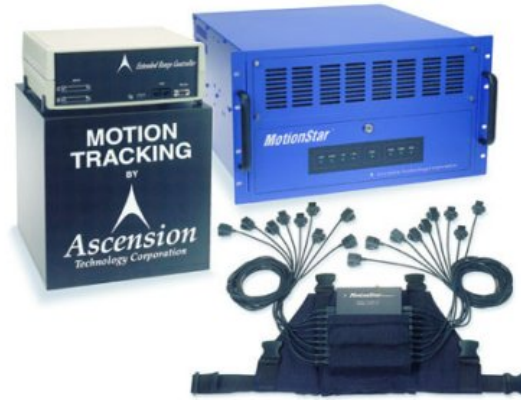
Figura 1.13. Componentes de captura de movimiento del MotionStar Wireless 2 .
