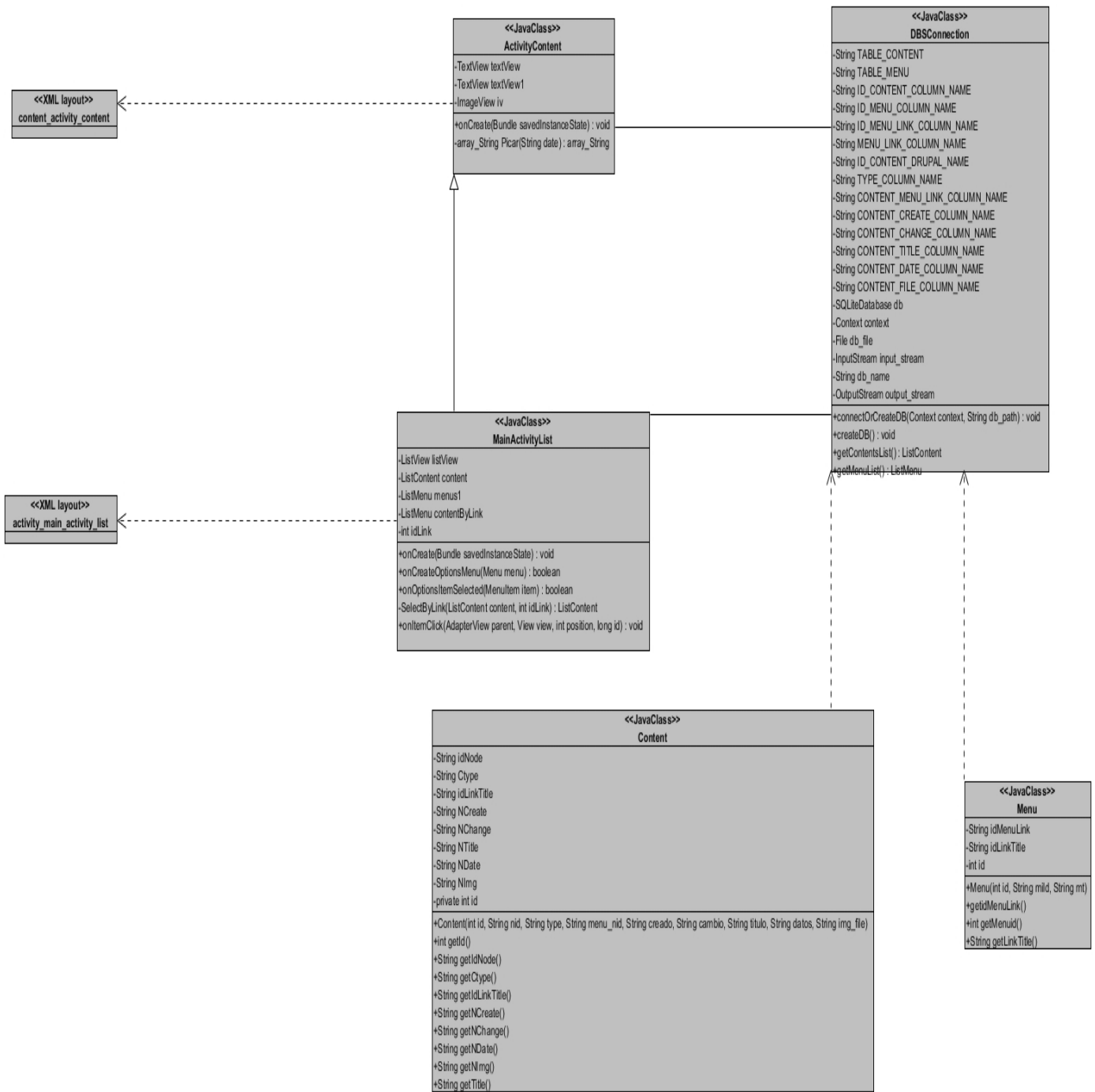
Figura 13. Diagrama de clases de diseño. Aplicación.
