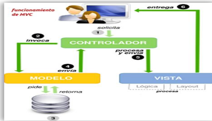
Fig. 5 Comportamiento de la arquitectura Modelo-Vista-Controlador.
