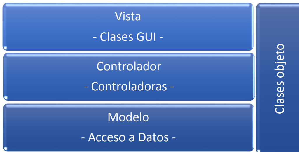
Ilustración 7: Patrón arquitectónico Modelo – Vista - Controlador.
