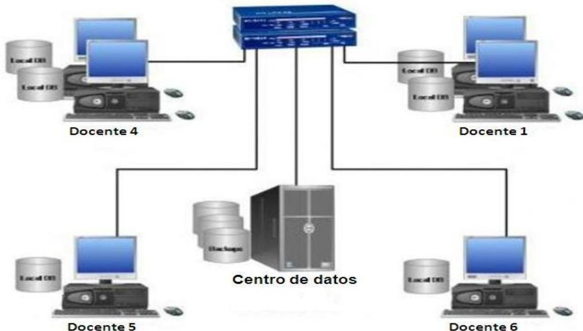
Figura 1 Interconexión de un sistema de BDD
