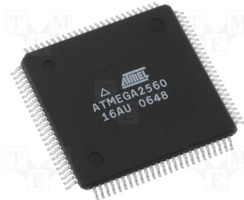
Figura 1.2. Microcontrolador ATMEL: ATMEGA2560.
