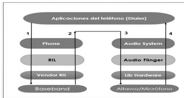
**Figura 7. Estructura de una llamada telefónica en el SO Android.**
