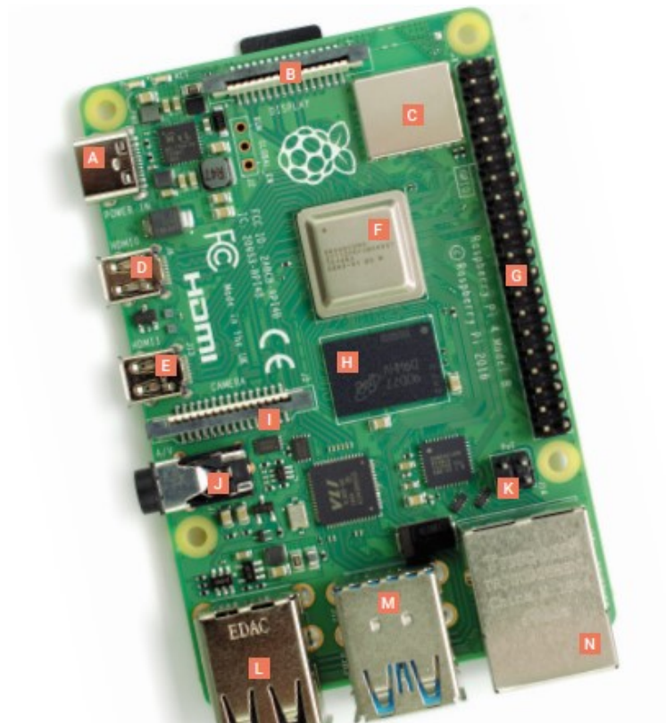
Figura 1.11. Raspberry Pi Componentes. Fuente: (Halfacree, 2024).
