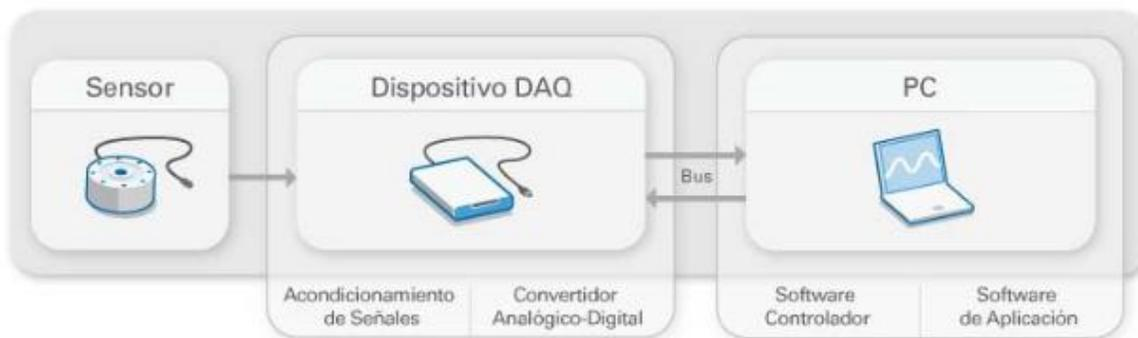
Figura 4 Partes del sistema DAQ [Fuente:(Aguero 2017)]
