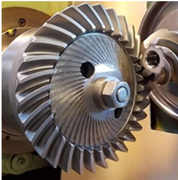
Figura 1.3. Engranajes cónicos helicoidales utilizados en la industria.
