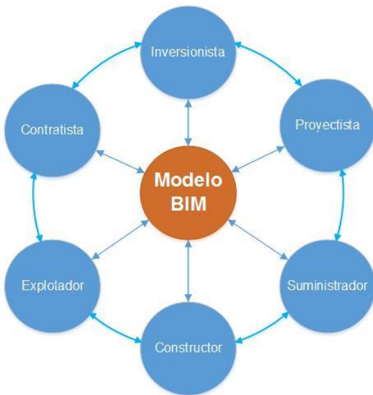
Figura 1. Esquema de interacciones entre los sujetos del Proceso Inversionista con las herramientas actuales, según Autor.
