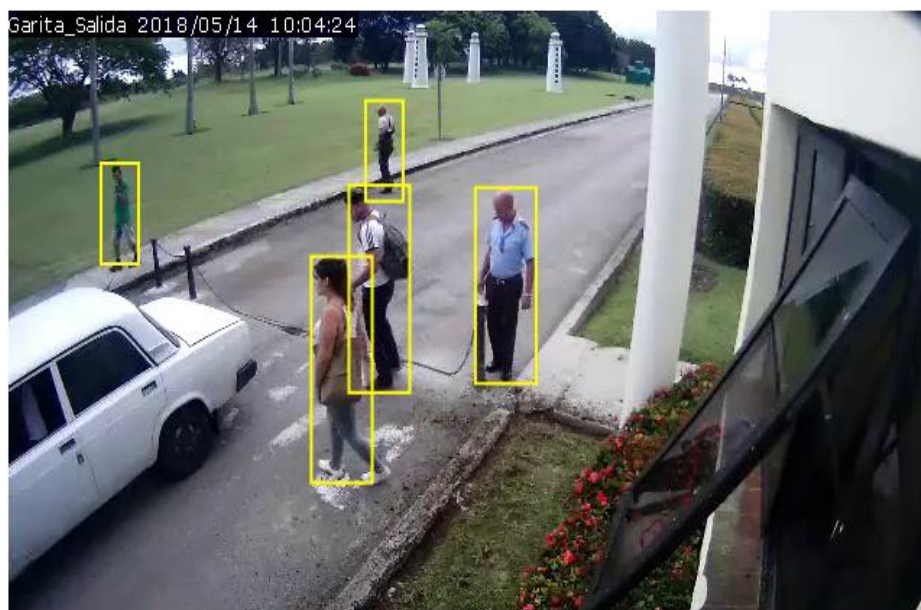
Figura 3. Flujo de video captado por Xilema Suria y detectando peatones.
